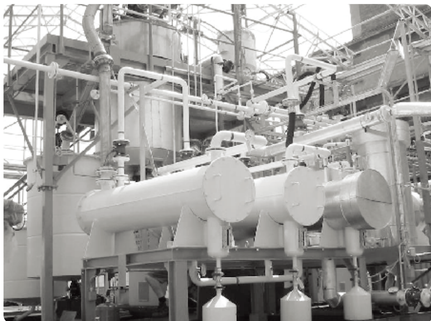
图31: 捷克斯国内拉托维采 Spolana工厂的第二个处理步骤——以碱催化脱氯法破坏持久性有机污染物。资料来源: Kubal、Fairweather等人 (2004年)
