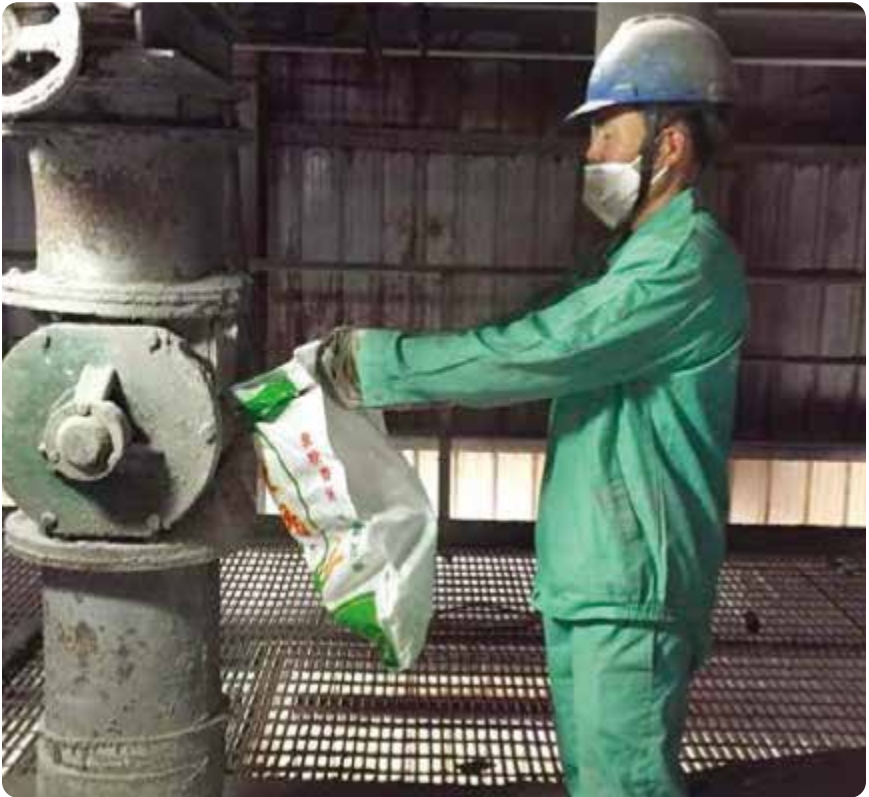
图13:中国废弃物焚烧设施飞灰样本收集,显示了设施的工作条件。 资料来源:Tang、Liu等人(2016年)
