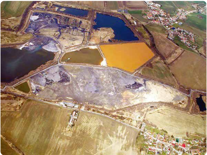
图12：捷克共和国南波希米亚州米德罗瓦里某工厂铀矿石再加工作业留下的污水贮留池航拍照片。这些污水池已被部分填充了包括飞灰在内的混合废弃物。资料来源：mail.oakrupkovo.cz。
