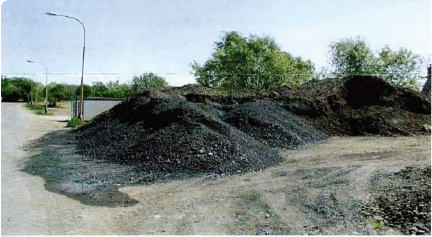
图27:捷克共和国利贝雷茨市 (Liberec) 市政废弃物焚烧设施的飞灰和炉渣混合物的临时储存场地, 它们日后会在某个城市被用作建筑材料。该材料中的二噁英和呋喃含量水平为0.05-0.1 ppb世卫组织毒性当量。主管部门曾经禁止在危险废弃物填埋场以外的其他任何地方处置飞灰, 但自2005年以来, 事情有变。
