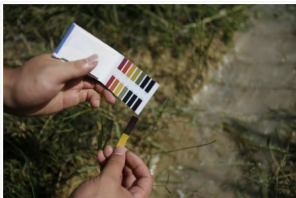
四坑库区的从库区流向农田的渗漏水呈碱性 2019 年 9 月
